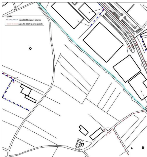
Figura 4 - Stralcio planimetrico della linea elettrica fornito dall'Ente gestore, area centro
